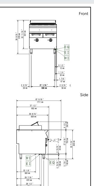
125 mm Electrical inlet (power) Equipotential screw
